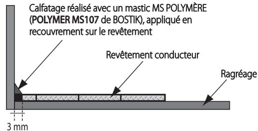
Pose suivant classification E3 : voir Principe de Mise en Œuvre REMONTÉE EN PLINTHE.
